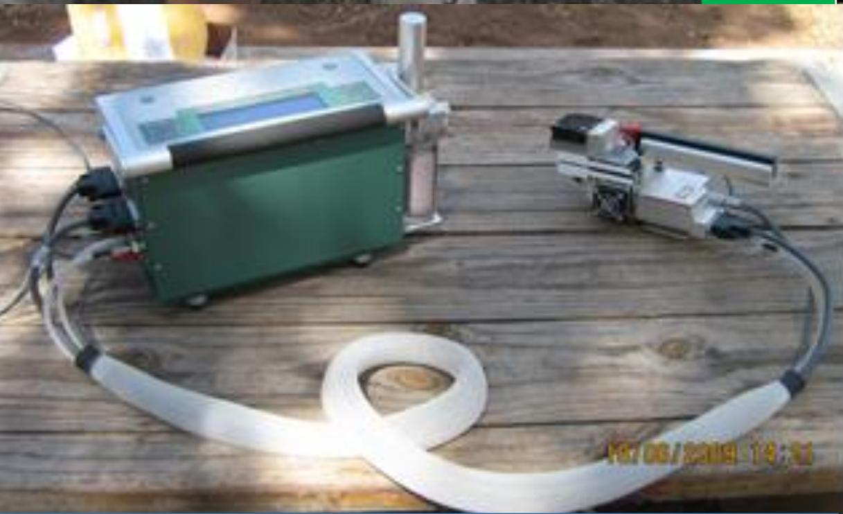
Autoporomètre Li-cor 6400
